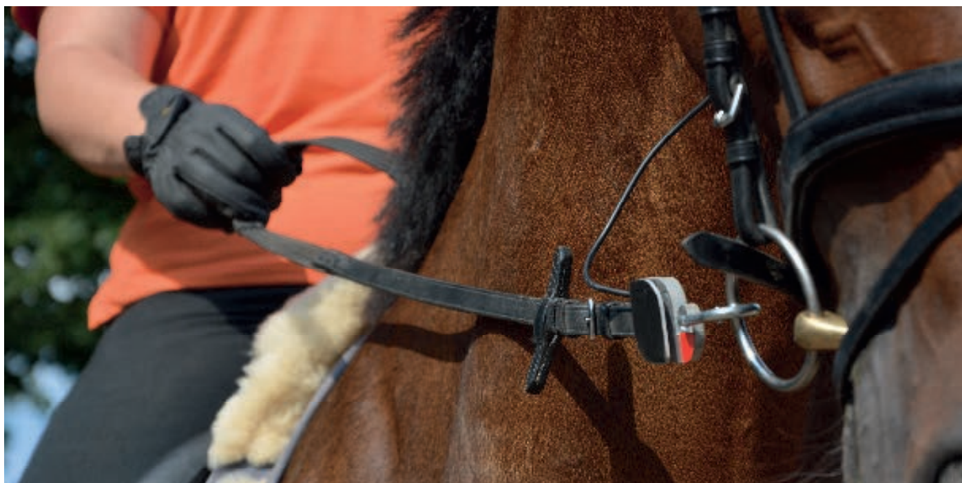
De Teugeldrukmeter bestaat uit 2 sensoren die bevestigd worden tussen het bit en de teugel. Het meet de trekkracht die ontstaat tussen de ruiterhand en de mond van het paard. Op de laptop kan de teugeldruk direct afgelezen worden in een grafiek.
